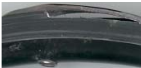
Hinterradfelge platzte bei einer Wandstärke von 0.8mm
