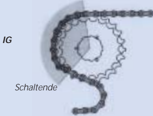
IG-Kassetten: Die Kette reitet zunächst auf dem nächsten Ritzel auf, bevor sie richtig einrastet.
