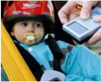
Kurz vor dem Start. MSR Mess-Computer zeichnet 200x pro Sekunde jede Bewegung auf.
