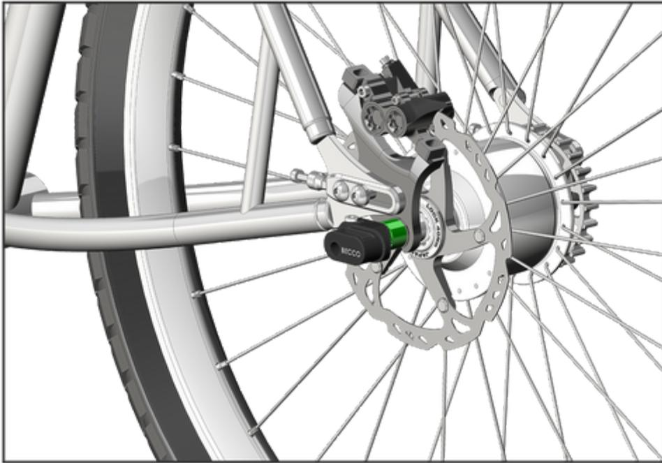
Vor dem Anbringen der **Leggero** Deichsel, schieb den **BECCO**-Adapter über den Adapter und benutze einen ISK.-Schlüssel **3mm**, um die Zylinderschraube **M5 x 25mm** des BECCO-Adapters mit einem Anzugsmoment von **max. 5 Nm** festzuziehen.
