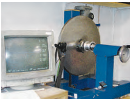
Dynamotestcenter: Andreas Oehler der Firma Schmidt misst im «Ausrollverfahren» Spannung, Strom und Geschwindigkeit. Die Datenauswertung erfolgt am PC.
