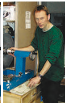
Dynamotestcenter: Andreas Oehler der Firma Schmidt misst im «Ausrollverfahren» Spannung, Strom und Geschwindigkeit. Die Datenauswertung erfolgt am PC.
