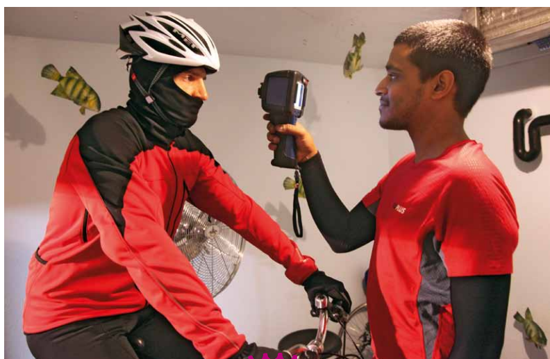
Kühler Test: Im Kältelabor blies bei 9 Grad Temperatur ein simulierter Wind von 20 km/h.
