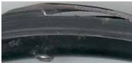
Hinterradfelge platzte bei einer Wandstärke von 0.8mm
